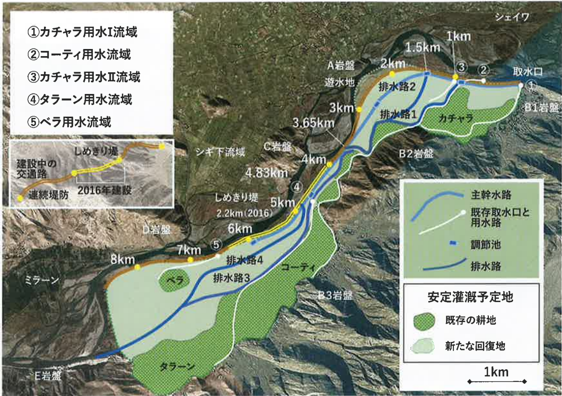
建設中の交通路・連続堤防及び用水路・排水路予定ルート
